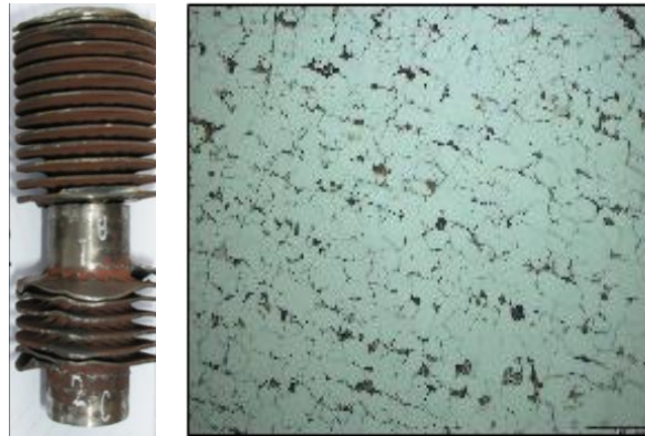
Figura 5. Material afectado por temperatura (Perlita Laminar).
