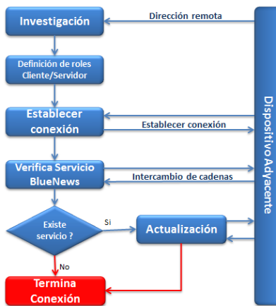
Figura 4. Diagrama de flujo del modo Cliente/Servidor.
