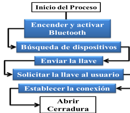
Figura 3. Proceso de establecimiento de la conexión bluetooth.
