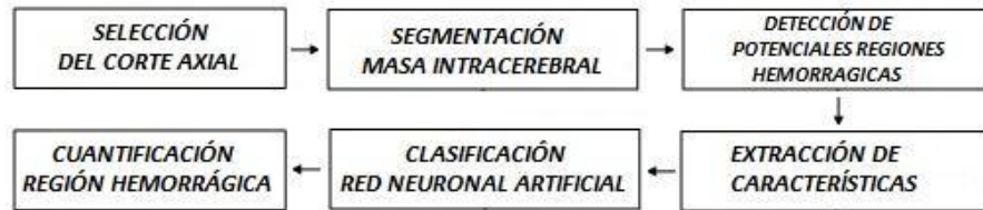
Figura 1. Esquema general del Sistema de Visión Artificial.
